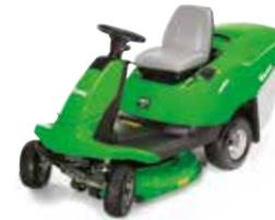
Mit dem agilen Reitermäher von VIKING ist nicht nur eine hohe Mähleistung gewährleistet, sondern auch jede Menge Fahrspass. Benzin/Rasenfläche: bis 4000 m²/Schnittbreite: 80 cm/VIKING OHV Benzinmotor/Leistung: 7,6 kW/10,3 PS/Hydrostatischer Fahrtrieb/Grasfangkorb: 250 l/Gewicht: 197 kg
