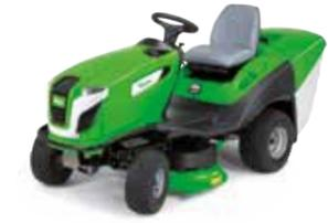
Dass Komfort und Leistung nicht allein der Oberklasse vorbehalten sind, zeigt der MT 5097. Man nimmt Platz auf einem gefederten, auf fast jede Körpergrösse einstellbaren Sitz. Benzin/Rasenfläche: bis 6000 m²/Schnittbreite: 95 cm/B&S OHV Benzinmotor/Leistung: 6,5 kW/8,8 PS/Hydrostatischer Fahrtrieb/Grasfangkorb: 250 l/Gewicht: 228 kg
