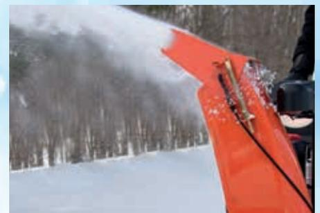
Die Auswurfweite beträgt bis zu 15 Meter. Dank des Kamins aus Stahlblech entsteht auch kein Schaden, wenn Eis oder Verunreinigungen mit ausgeworfen werden.
