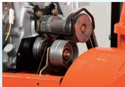
Der einzigartige 2-Riemenantrieb (Deluxe und Professional) garantiert eine maximale und verlustarme Kraftübertragung zum Fräsaggregat.
