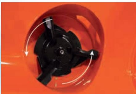
Der gross dimensionierte Auswurfkanal und die speziell geformten Schaufeln sorgen dafür, dass selbst nasser Schnee ausgeworfen und nicht der Kanal oder der Kamin verstopft wird.
